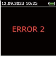
A smartphone screen displaying the date and time '12.09.2023 10:25' at the top. The main content of the screen is a black background with the text 'ERROR 2' in red, bold, uppercase letters. | <p><b>erro do sensor</b></p> <p>- O sensor está danificado. Entre em contato com um centro de serviço.</p>                       |
