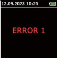
A smartphone screen displaying the date and time '12.09.2023 10:25' at the top. The main content of the screen is a black background with the text 'ERROR 1' in red, bold, uppercase letters. | <p><b>Erro no sensor de pressão</b></p> <p>- O sensor de pressão está danificado. Entre em contato com um centro de serviço.</p> |
